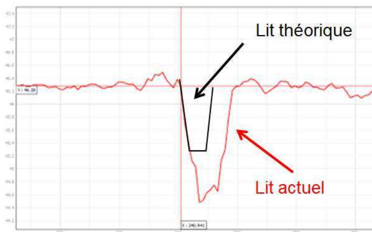
Figure 14 - Gabarit actuel et théorique du lit mineur en amont du hameau de Berteau
